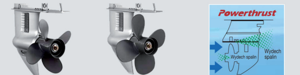
Śruba standardowa Śruba Power Thrust Napór wody przy biegu wstecznym
